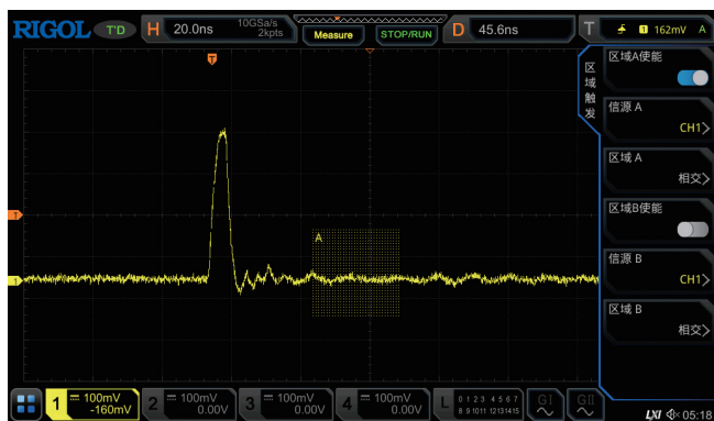
通过边沿触发 + 区域触发，简单快速地分离异常信号
