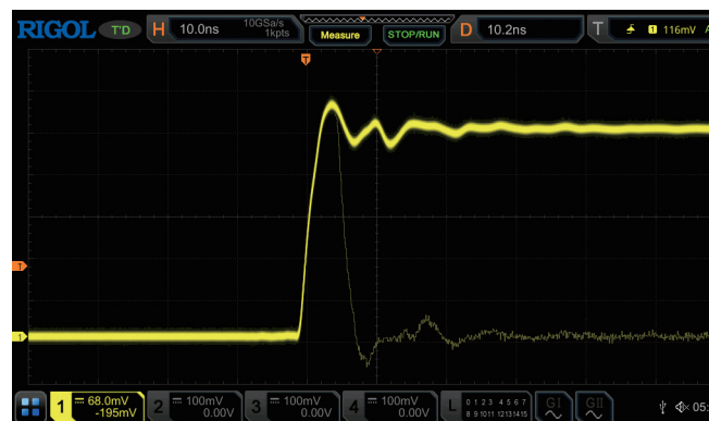
高刷新率模式下捕获偶发异常信号
